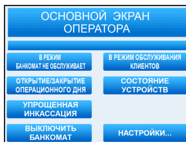
Рис. 13. Экранная форма «Основной экран оператора»
