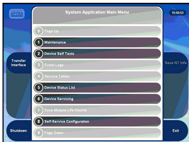
Рис. 16. Вид диагностической программы «Aptra System Application» для УС NCR
